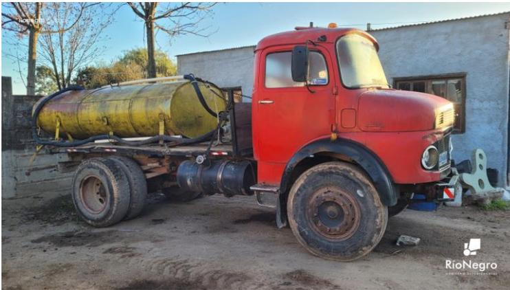
Se realizó el montaje del tanque de riego sobre el camión que operaba en tareas de poda, ya que la misma finalizó.
